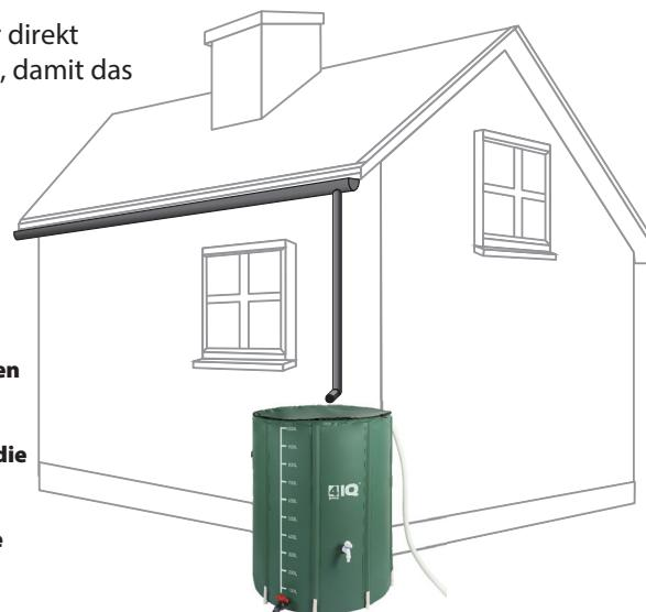
**Der Behälter sollte auf einer ebenen Fläche stehen, auf der keine Gegenstände liegen, die ihn beschädigen könnten. Prüfen Sie die Teile vor dem Zusammenbau auf Beschädigungen - bei Beschädigungen unterbrechen Sie bitte die weitere Montage.**
