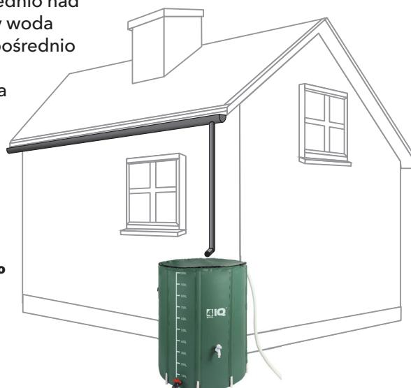
**Zbiornik powinien być ustawiony na płaskim podłożu wolnym od wszelkich elementów mogących go uszkodzić. Przed przystąpieniem do składania należy sprawdzić czy części nie są uszkodzone - w przypadku uszkodzeń prosimy zaprzestać dalszego składania.**
